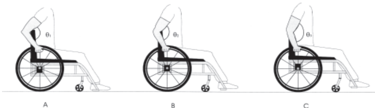
Figura 30 – Variação da altura do encosto influenciando no ângulo de abertura do cotovelo. Uma maior altura do encosto (A) resulta em menor abertura do cotovelo, prejudicando a impulsão. Com a redução
